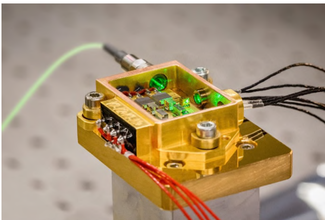
Abb. 1 Klein, aber oho: Das in Jena aufgebaute Festkörperlasermodul vereint kleine Baugröße mit größter Robustheit.
