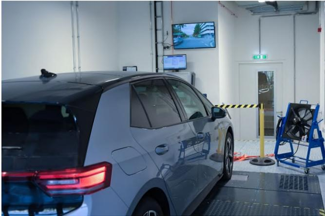
**Das Team am Fraunhofer IIS/EAS baut ein eigenes Vehicle-in-the-loop-Labor auf. Hersteller können ihre Fahrzeuge in der virtuellen Umgebung testen und zertifizieren.**
