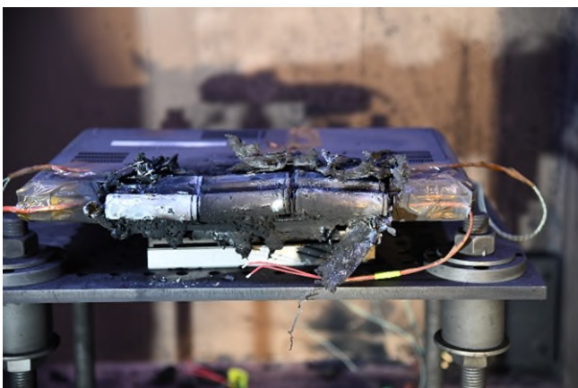
Abb. 4 Ein zerstörter Laptop nach dem thermischen Durchgehen
