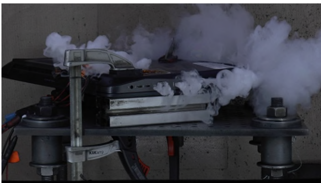
Abb. 1 Ausgasen einer Laptopbatterie während des thermischen Durchgehens
