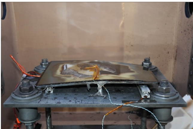
Abb. 3 Ein zerstörtes Tablet nach dem thermischen Durchgehen
