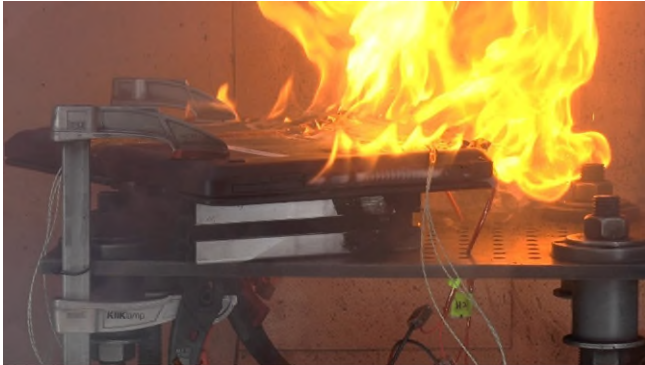
Abb. 2 Brand eines Laptops während des thermischen Durchgehens
