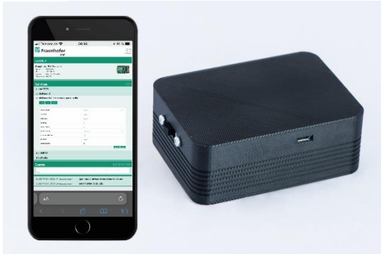
Abb. 1 Die Klickerkennung des Fraunhofer IDMT kann in das Meldewesen integriert und über ein Interface dargestellt werden. Das Mikrofon lässt sich in einem Arbeitshandschuh integrieren, auch die Kombination mit einer Smartwatch ist möglich.
