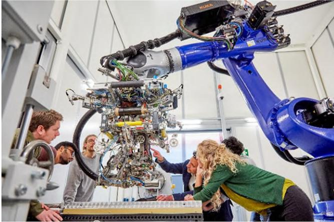
**Abb. 1** Am Fraunhofer IAP wird die Automated-Fiber-Placement-Technologie (AFP) eingesetzt, um neuartige, sehr leichte Antriebswellen aus carbonfaserverstärkten Kunststoffen herzustellen. Dank der thermoplastischen Matrix sind die Bauteile recyclebar.
