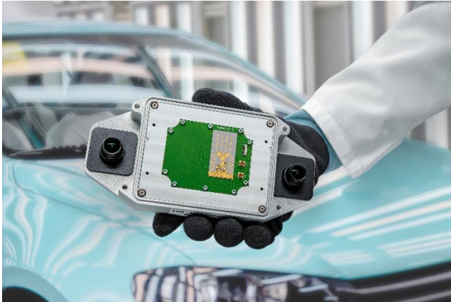
Abb. 2 Die Plug & Play-Sensorplattformen des Fraunhofer IZM ermöglichen schnelles Testen und Validieren von Konzeptideen für drahtlose Sensorik und Radarsensorik.
