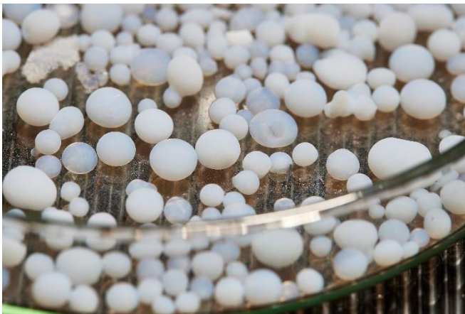
Abb. 2 Das Aerogel wird mit einer Korngröße von zwei bis vier Millimetern in den Dämmputz integriert.
