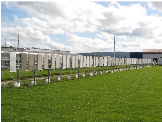
Abb. 1 Bei der Freibewitterung werden Fassadenputze 18 Monate lang der Witterung ausgesetzt. Nach jedem Regenereignis werden die Proben im Labor untersucht.
