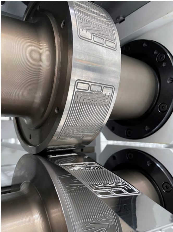
Abb. 1 Hohlprägewalzen von Bipolarplatten mit der BPPflexRoll. In der neu entwickelten Technologie wird die Struktur der Bipolarplatte durch ein Walzenpaar geprägt.
