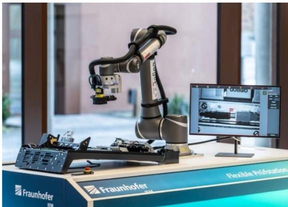
**Abb. 2 Die KI-gestützte Bildauswertung ist direkt im Kameramodul des Roboterarms integriert. Wenn die Analysesoftware Mängel entdeckt, benachrichtigt das System die Mitarbeitenden, die den Fehler beheben können.**
