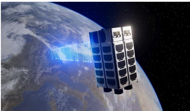
Abb. 1 Projekt CubEniK für hochsichere Verschlüsselung: Der Mini-Satellit kann Quantenschlüssel über eine Entfernung von 300 Kilometern zwischen zwei Bodenstationen übertragen.
