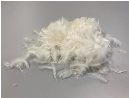
Abb. 1 Federn enthalten Keratin, ein wasserunlösliches Strukturprotein, aus dem sich Bestandteile von Klebstoffen herstellen lassen.
