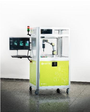
Der goROBOT3D kann durch intelligente Wärmebildgebung schwierig aufnehmbare Materialien dreidimensional erfassen und weiterverarbeiten. © Fraunhofer IOF
