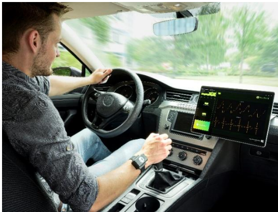
Abb. 3 Unauffällig beim Autofahren: Der Fahrer trägt am Handgelenk einen Sensorknoten und unter dem Hemd einen Brustgurt zur EKG-Erfassung. Auf dem Tablet wird das maphera®-User-Interface angezeigt, das die Daten in Echtzeit darstellt.
