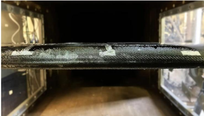
Abb. 2 Versuch im Vereisungswindkanal: An der eingebauten Flügelvorderkante bilden sich realistische Eisablagerungen.
