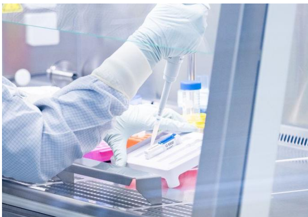
Abb. 2 Die Immunzellen des Patienten und das genetische Material für den ROR-1 Rezeptor werden in einer Küvette zusammengeführt. Durch das Anlegen elektrischer Impulse gelangt die Erbinformation in das Genom der Zelle.
