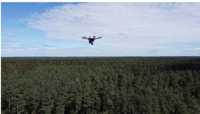
Abb. 2 Ein erster Technologiedemonstrator wurde bereits erfolgreich getestet: Er kann innerhalb weniger Minuten eine radioaktive Quelle bis auf wenige Meter genau aufspüren.
