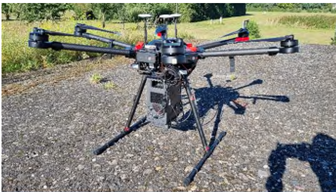
Abb. 1 Das hochautomatisierte UAS hat neben einem Gammadetektor elektrooptische und Infrarotkameras an Bord.
