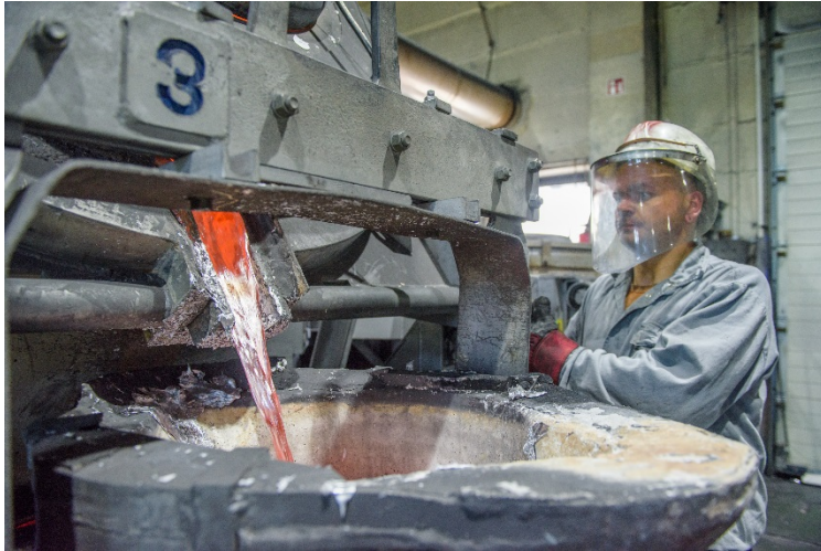
Bild 1. Umfüllen des geschmolzenen Metalls. Zum Schmelzen und Beheizen wird sehr viel Energie benötigt. Foto: Leichtmetallgießerei Bad Langensalza GmbH
