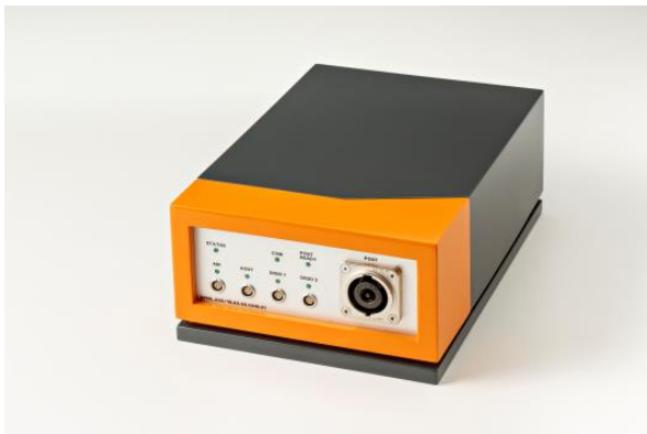
Leistungselektrische Hardware-in-the-Loop-Schnittstelle. Foto: Fraunhofer LBF / Raapke.
