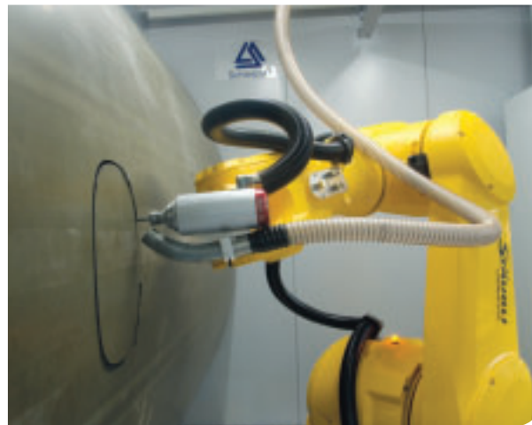
Der Roboter fräst Fensteröffnungen aus einer CFK-Flugzeugrumpfschale. © Fraunhofer IFAM
