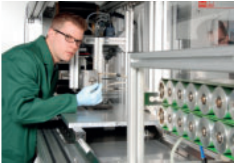
Fertigung des Führungsdrahtes aus faserverstärktem Kunststoff. © Fraunhofer IPT
