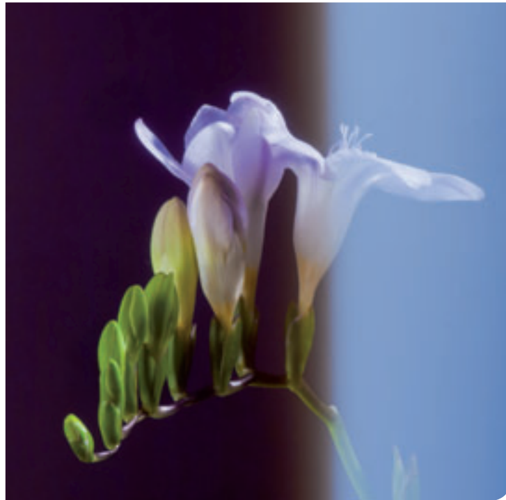
Noppenartige Nanostrukturen erhöhen die Transparenz von Klarsichtfolien. Die rechte Seite der Folie ist nicht mit Mikrostrukturen versehen. © Fraunhofer FEP
