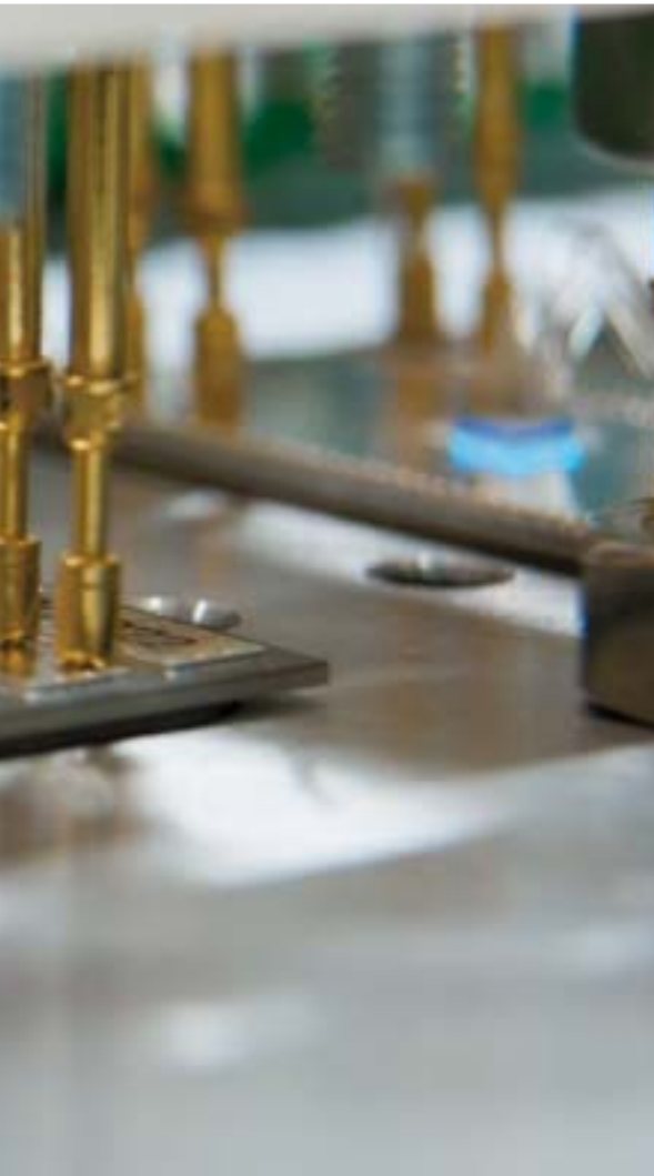
Lebensdauertests an SiC-Dioden im Labor für Aufbau- und Verbindungstechnik (AVT). © Fraunhofer IISB
