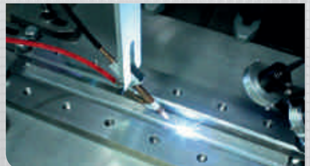
Mehrlagen-Engspaltschweißverfahren an einem 50 mm Blech. © Fraunhofer IWS
