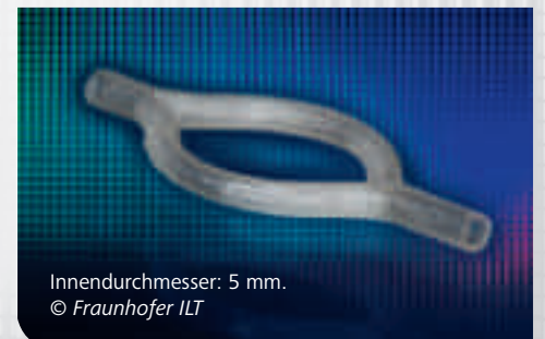
Laserstrukturierte, verzweigte Gefäße aus elastischem Polymer,
