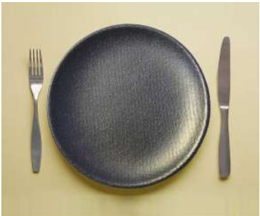
Der Teller wurde in Pilotversuchen aus einer Folie aus Zuckerrübenschnitzeln hergestellt Foto: Fraunhofer WKI
