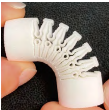
Die Gelenkstruktur kann problemlos um 90 Grad gebogen werden.
